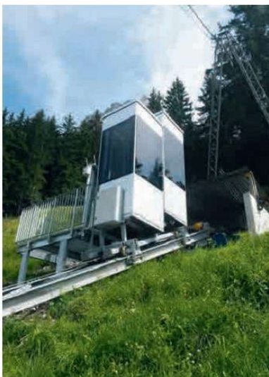
Die zwei Kabinen auf dem gemeinsamen Fahrwerk sind dank konstanter Neigung der Fahrbahn fest miteinander verbunden.
